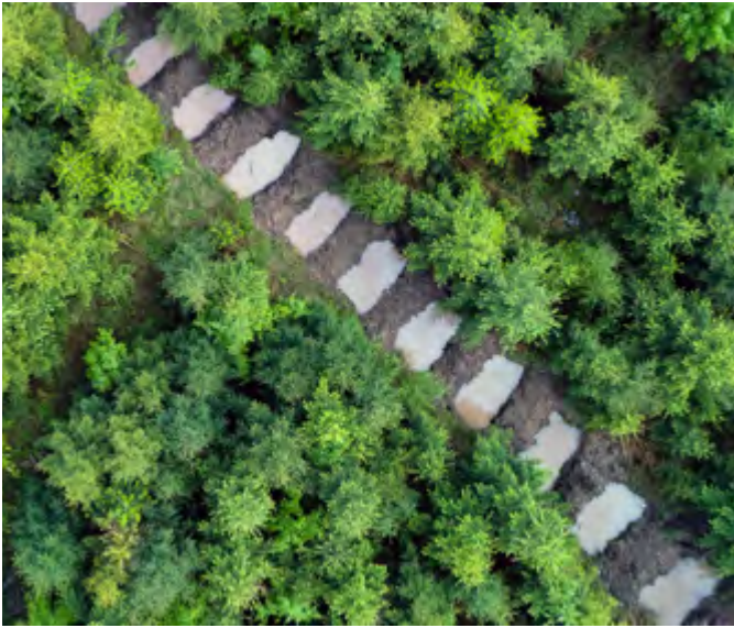
Obrázok 36a, b Revitalizácia vrstevnicovej technologickej linky alebo linky s malým sklonom. Infiltračné opatrenie typu Jama-Hrázda-Jama, s dôrazom na podporu biodiverzity (fotografia: © Miroslav Kubín)
